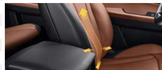
Regulacja podparcia lędźwiowego fotela kierowcy
