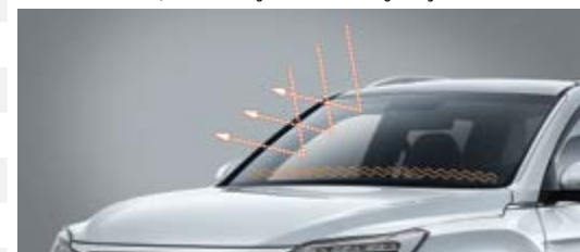
System odmrażania wycieraczek szyby przedniej
