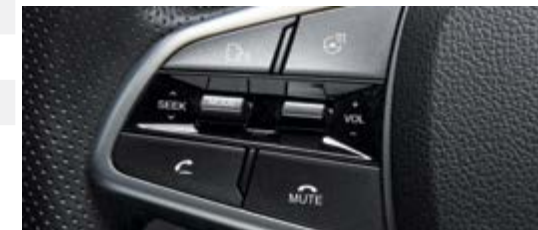
Moduł przełączników zdalnych w kierownicy
